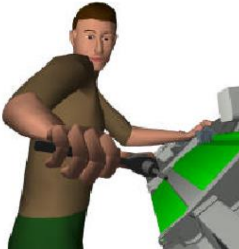
Figura 2 Quando si manipola un segmento, il software utilizza la cinematica inversa per determinare, in tempo reale, la posizione di segmenti e di articolazioni collegati.
